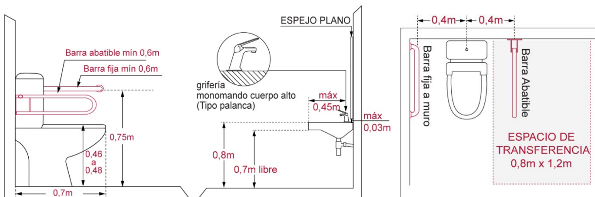
Fig 119 (izq): Requisitos para instalación de inodoro. Fig 120 (centro): Requisitos para instalación de lavamanos. Fig 121 (der): Espacio de transferencia a un costado del inodoro.
