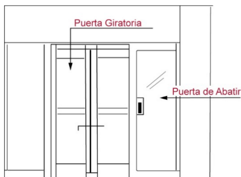
Fig. 65: Cuando se contemplen puertas giratorias en el acceso debe existir adicionalmente una puerta de abatir contigua,
